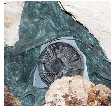
Cela peut être réalisé à l'aide d'un ventilateur équipé d'une bâche permettant d'isoler l'accès à la cavité et de provoquer soit une dépression soit une surpression.
