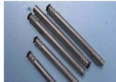
Il est possible de régler la charge en plaçant plusieurs renforçateurs dans le même trou de mine.
