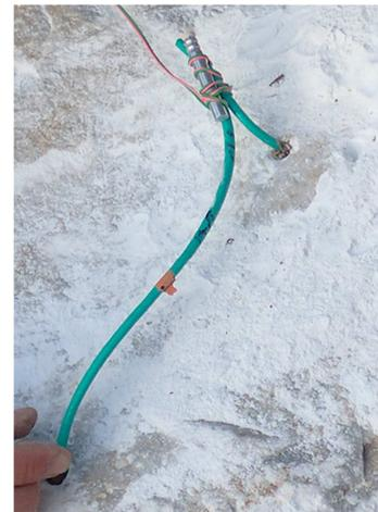
Dans le cas où on serait limité par la quantité de détonateurs disponibles sur place, il est possible de relier les différentes charges d'explosifs à l'aide de cordeau détonant de petit diamètre placé au contact de la charge dans le trou de mine et relié à un seul détonateur à l'extérieur.
