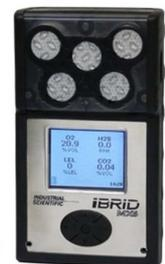
*Remarque* : certains capteurs dérivent et/ou se dégradent au cours du temps. Il est donc vital de faire réviser l'appareil régulièrement afin de faire changer les capteurs en fin de vie et de faire étalonner les autres.
